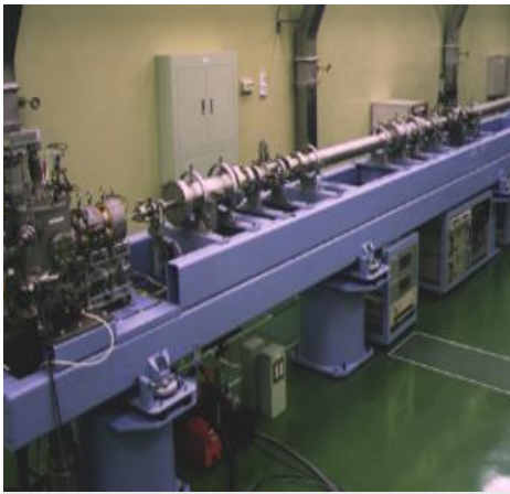
図 6 QST 高崎イオン照射研究施設 TIARA に設置されている PBW ビームライン
