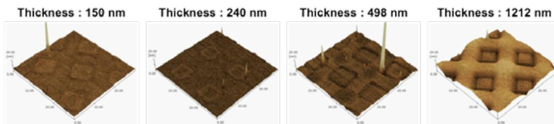
図 4 光二量化基含有ポリマーフィルムの表面パターンニング特性
