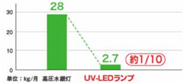
図-3 高圧水銀灯 (250W) および UV-LED ランプ (24W) を 1 日あたり 8 時間使用した際の CO 2 排出量
