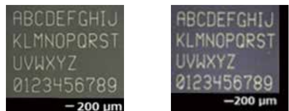
図 7 レーザー印字後の保護フィルム観察像 左：既存製品（熱硬化型） 右：開発品（UV 硬化型）
