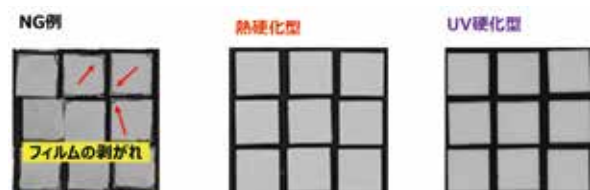
図 8 接着信頼性試験後のチップ裏面保護フィルムの SAT 像
