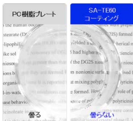
Figure6 SA-TE60 をコーティングした PC 樹脂の防曇性 50°C蒸気暴露 1 分後の外観 (乾燥膜厚: 30 \mu\text{m} )
